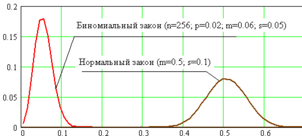
Рисунок 1 – Биномиальный закон распределения значений при равновероятном и не равновероятном значениях состояний «0», «1» разрядов выходного кода
